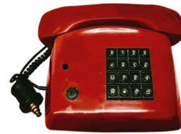
Ab 1970. Das Tastentelefon gab es in modischen Farben. Nummern konnten eingespeichert werden, links unten wurde es versperrt. Die Anordnung der Nummern folgte dem Beispiel der Wählscheibe.
