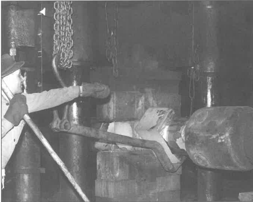
Abb. 10: Judenburg. Schmieden einer Kurbelwelle im Preßwerk. Mit 1967 datierte Aufnahme im Besitz von H. J. Köstler.
