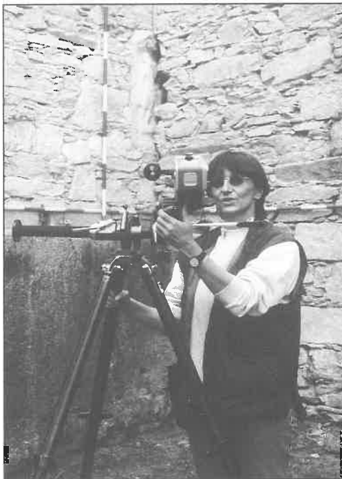
Abb. 4 und 5: Fotogrammetrische Aufnahme freigelegten Mauerwerks mit römischen Spolien. Pfarrkirche St. Johann bei Herberstein. (Foto: ARGIS - G. Fuchs). Rechts: Geodätische Vermessung zur Dokumentation von Bodendenkmalen. (Foto: ARGIS - I. Kainz)
